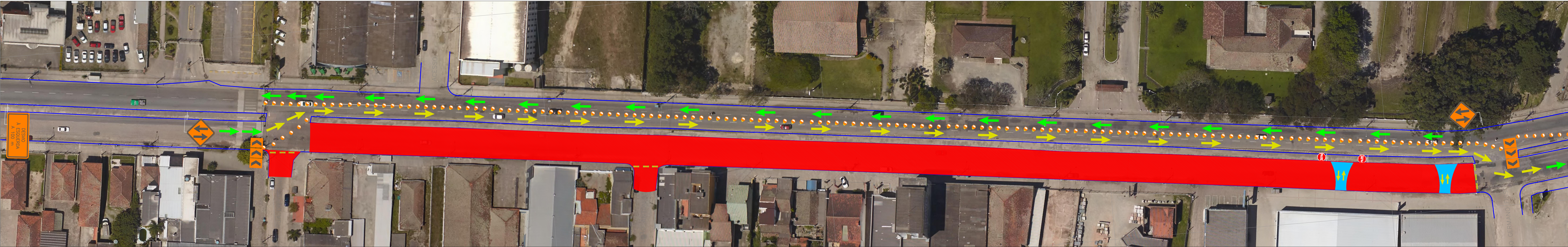
DETALHE 2 - SINALIZAÇÃO DE OBRA - ESCAVAÇÃO BRUNO CHAVES x GERMANO FISS ESC: 1:1000
